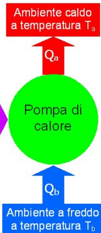
Le pompe di calore sono macchine termiche che operano trasferendo calore da una sorgente fredda ad una calda. Lo schema di funzionamento è quello di un condizionatore che lavora a **rovescio**.
